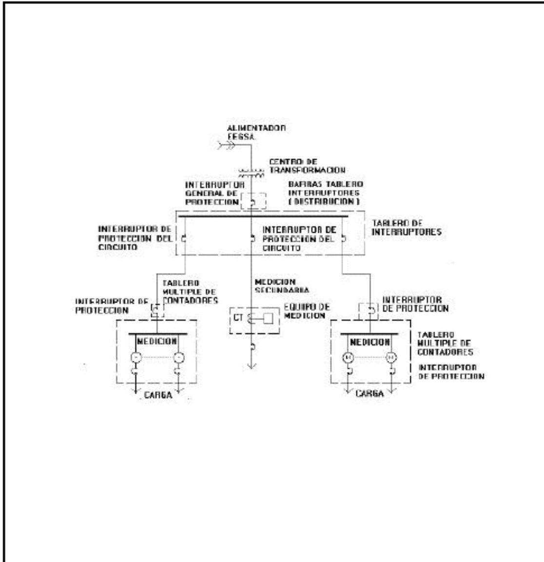
**ESPECIFICACIONES PARA INSTALACIÓN DE TABLEROS MÚLTIPLES DE CONTADORES Y MEDICION EN CAJA TIPO III A MÁS DE 5 METROS**
